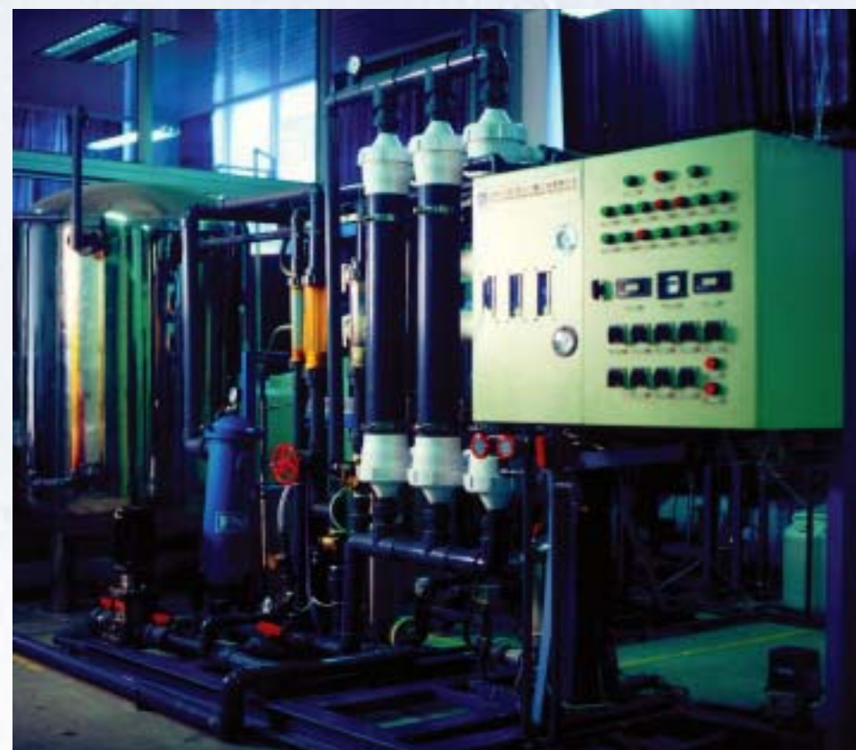
反渗透淡化装置
